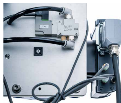
Das 3/2-Wege-Ventil VQZ 332 bläst die Frässpäne mit einem kräftigen, punktgenauen Luftimpuls aus dem Arbeitsraum – so bleibt der Kappenwechsel frei von Rückständen und die Anlage im Takt. (© SMC Deutschland GmbH / Timo Lutz Fotografie)
