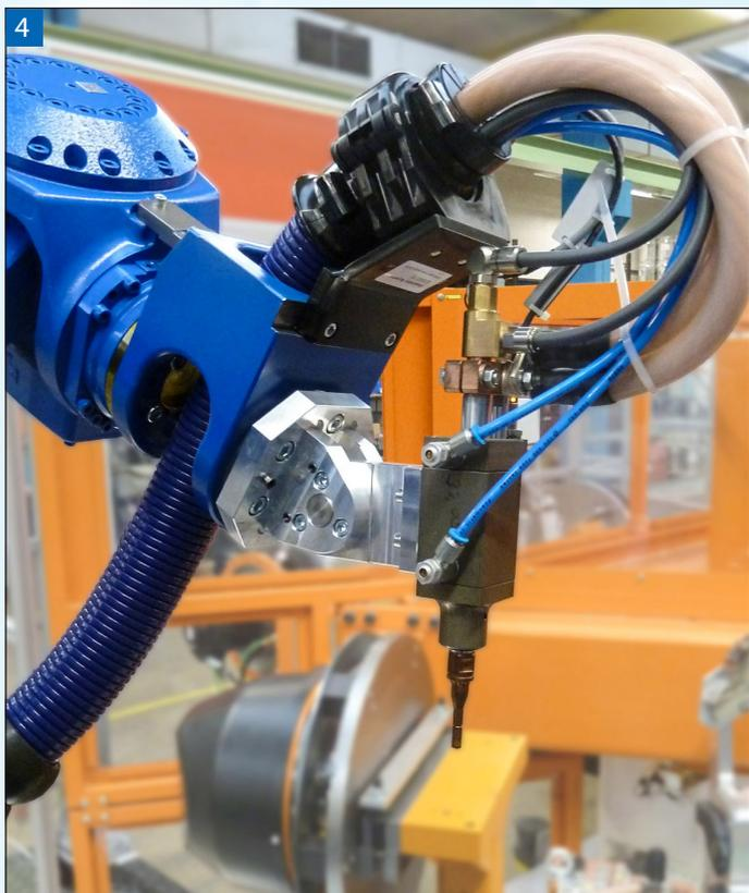
Für die Nachbearbeitung der DALEX-Stoßpunkter entwickelten die Experten von KYOKUTOH einen speziellen Ausgleich für ihren Kappenfräser, der eine hohe Stabilität des Systems gewährleistet.
